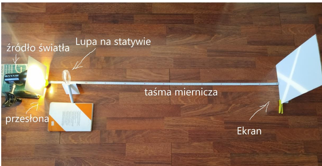
Rys.1. Zdjęcie przykładowego zestawu do wyznaczenia zdolności skupiającej soczewki (tu: lupy)
