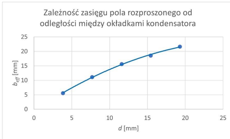
Rys. 3. Zasięg pola rozproszonego b_{eff} wokół kondensatora o kwadratowych okładkach. Zasięg ten jest tym mniejszy im mniejsza jest odległość między okładkami, d . Jest ona porównywalna z tą odległością.
