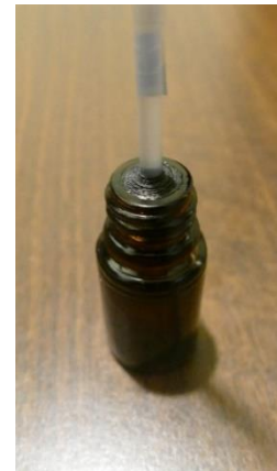
Rys. 3. Uszczelnienie wykonane taśmą izolacyjną.
