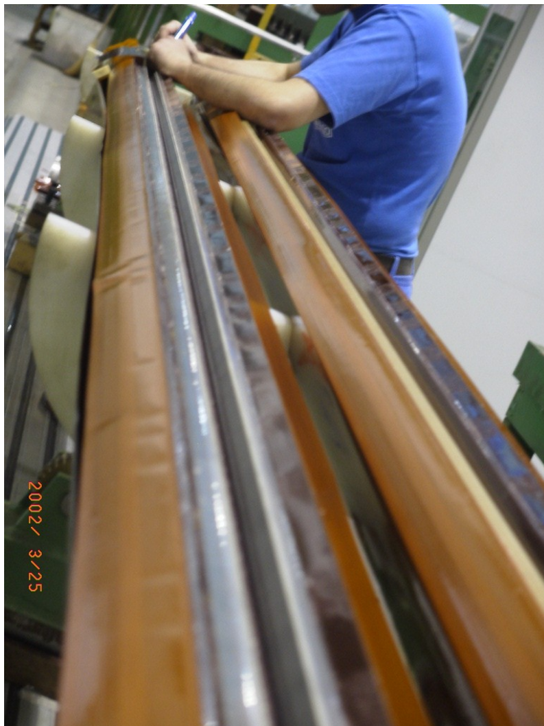
Montaż grzejników quenchujących
