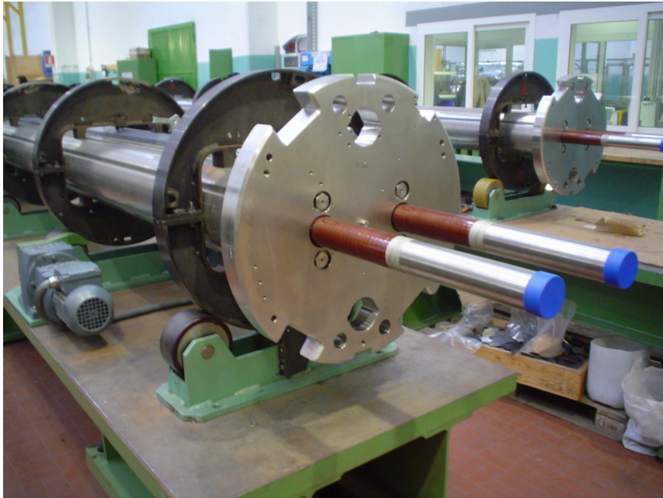
Etap zaciskania cewek w kołnierzu ze stali nierdzewnej
